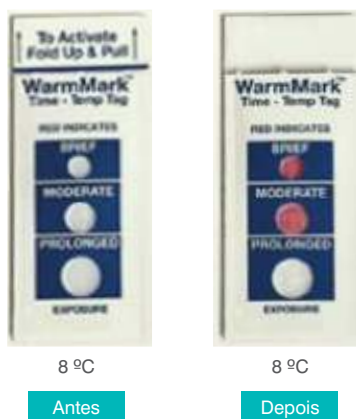
Fig. 9 | Exemplo de uma tira indicadora de temperatura e seu modo de funcionamento.
